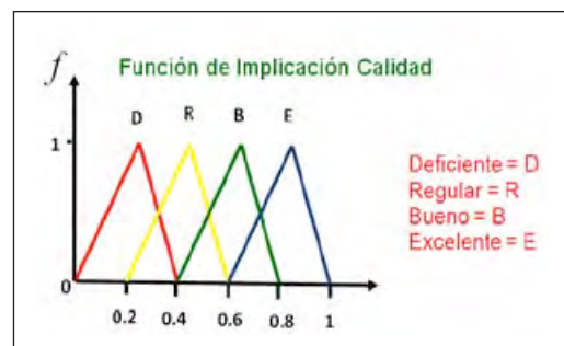
Figura 12. Función de Implicación para defusificar y medir la calidad del medio de transmisión.
