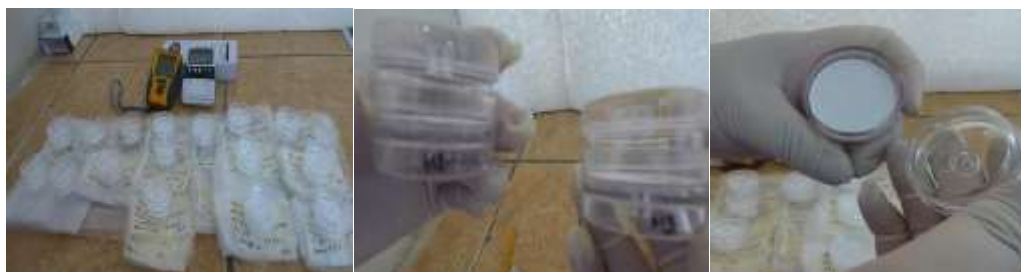
Figura 2. Cassetes portadores de muestras (izquierda), cassetes que contienen los filtros con muestras (centro) y filtros dentro de los cassetes (derecha)
