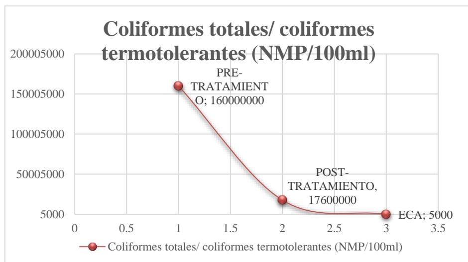
Figura 2 – Coliformes Totales y Termotolerantes de entrada y salida en comparación a lo establecido por el ECA – agua en el humedal artificial piloto.
