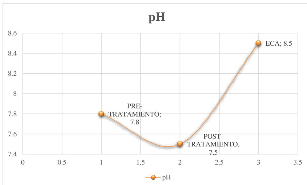
Figura 4 – Reducción del pH pre y post tratamiento dentro del humedal artificial a escala piloto
