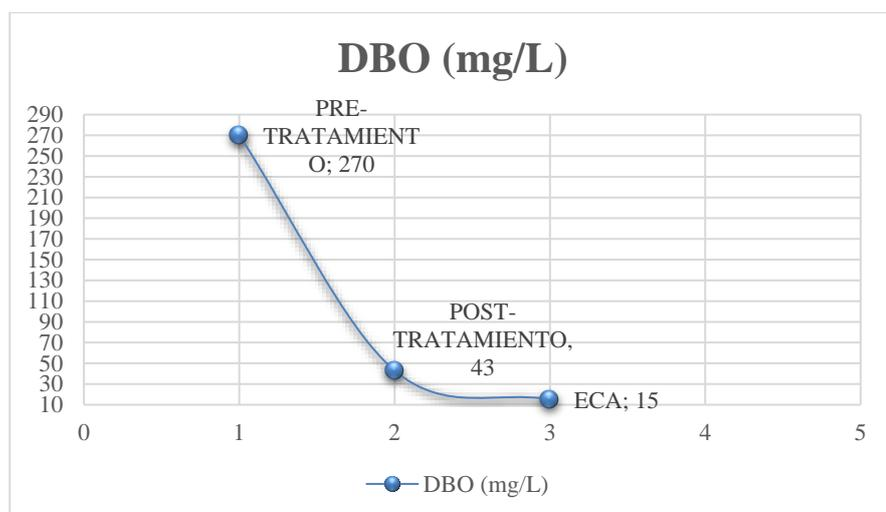
Figura 1 - DBO de entrada contra DBO de salida y DBO establecido en el ECA – agua en humedal artificial piloto.
