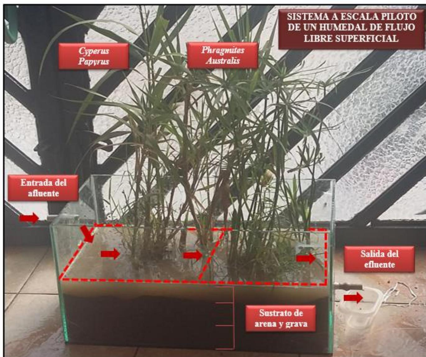
En la figura se puede apreciar el montaje del experimento la entrada del agua residual y la salida del agua después del tratamiento en el humedal con plantas emergentes *Cyperus Papyrus* y *Phragmites Australis*, el sustrato de arena y grava.
