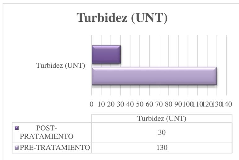
Figura 3 – Reducción de turbidez pre y post tratamiento del humedal artificial a escala piloto.
