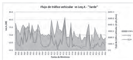
Figura 3. Niveles de ruido versus flujo de tráfico vehicular: Período tarde (e)
